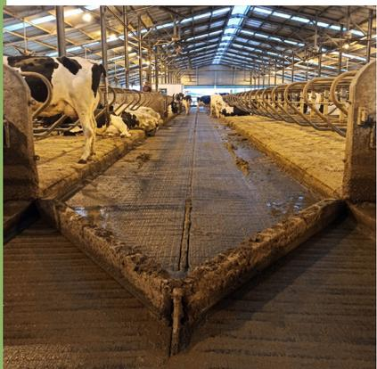
Raschiatore per invio immediato effluenti in digestione
